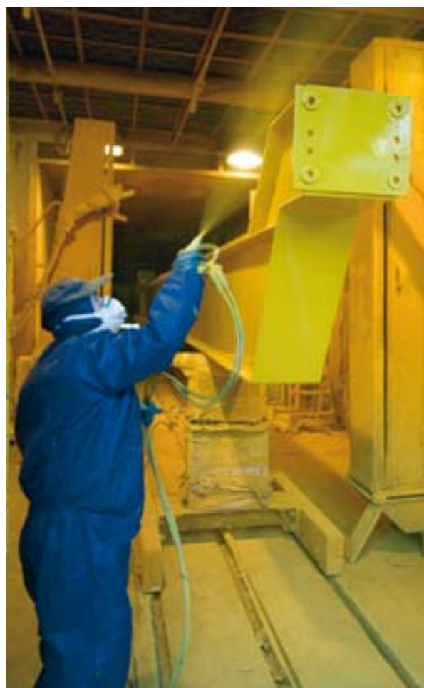
In alto il paranco a fune Demag DR, sotto verniciatura di una trave negli stabilimenti Demag
