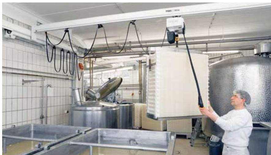
Il design compatto consente di risparmiare spazio: le griglie impilate vengono trasferite nella salamoia
